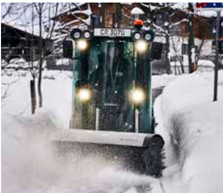
Kehrmaschine mit 3. Besen
