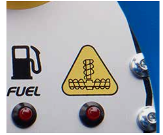
Warnsystem Überlastung Förderschnecken
